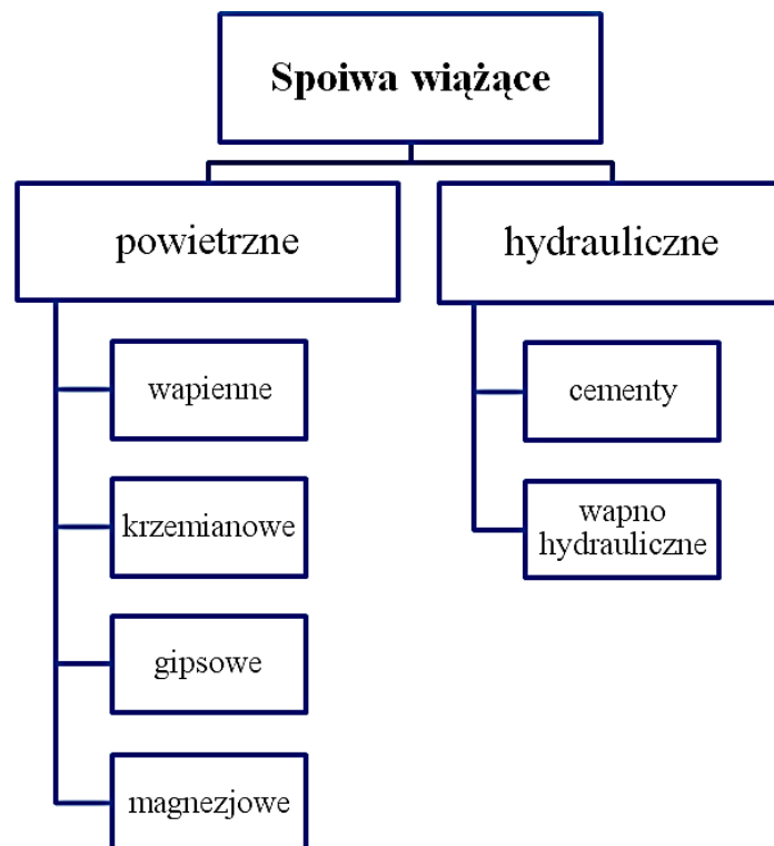
Rys.1. Klasyfikacja spoiw wiążących ze względu na ich zachowanie w środowisku wodnym
